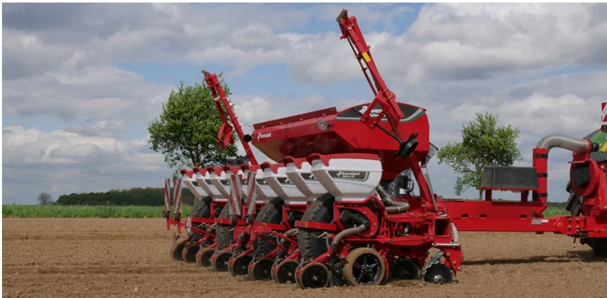
Kverneland Optima TFprofi equipaggiata con l'unità di semina SX ad alta velocità
